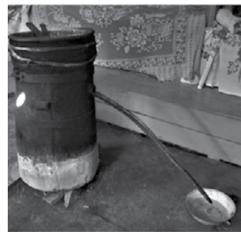
Аппарат для изготовления арачки (молочной водки)
