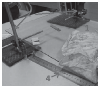
Рисунок 23. Установка для измерения коэффициента трения о стекло
